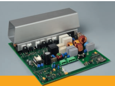
EMV-Herausforderung: Spannungswandler für Leistungselektronik gepaart mit Steuerungselektronik (oben) Elektronik mit Kühlkörper und Notfall-Lüfter (unten)
